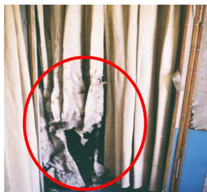
Foto 36 – Vista interna de avião, degradação das cortinas, causada pelo calor e chuva
