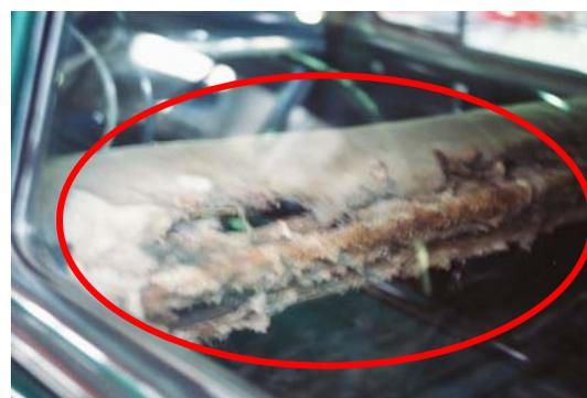
Foto 38 – Vista interna de carro, banco danificado pela ação do calor e da água (enchente)
