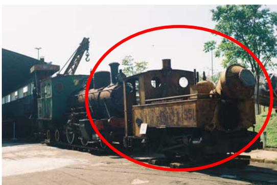
Foto 37 – Vista externa de locomotiva, com ferrugem, degradação causada pelo calor e chuva
