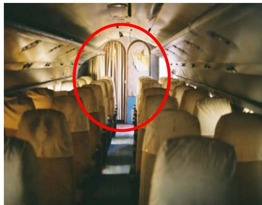
Foto 34 – Vista interna de avião, degradação causada pelo calor e chuva
