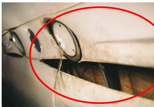
Foto 35 – Vista interna de avião, degradação do teto causada pelo calor e chuva
