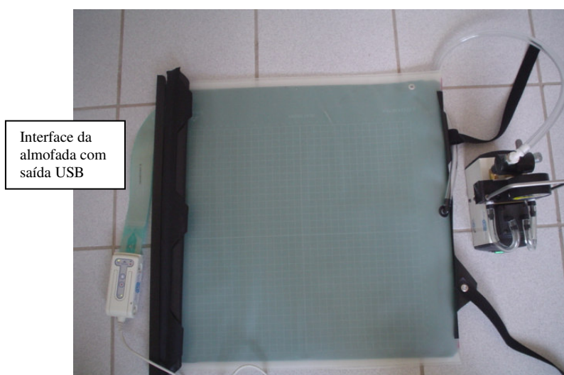
Figura 8 - Interface do sensor, ao lado esquerdo da foto, com saída USB para o computador
